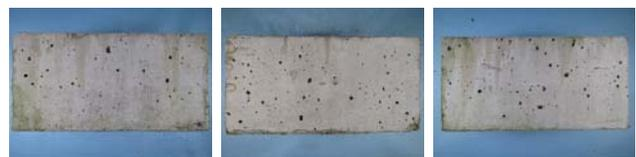
写真-2 暴露試験後のコンクリート表面
