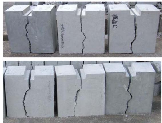
写真-2 角柱供試体の破壊状況
