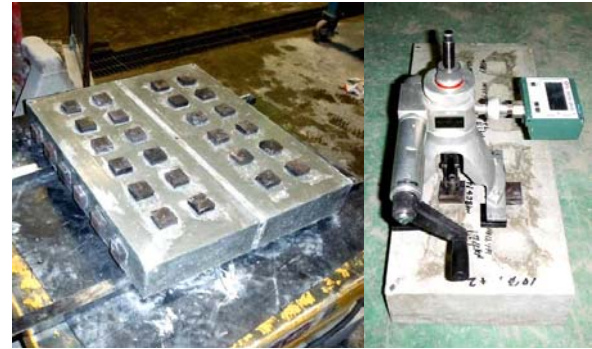
写真-1 脱型後の供試体と付着試験状況
