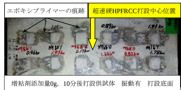
写真-2 付着試験後の供試体
