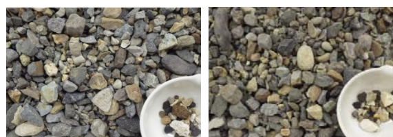
SPT 溶液使用 塩化亜鉛溶液使用 写真－7 試験終了後の粗骨材
