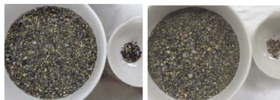
SPT 溶液使用 塩化亜鉛溶液使用 写真－6 試験終了後の細骨材
