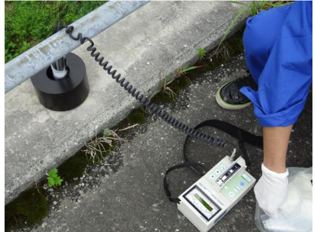
図－３ コリメータを使用した NaI シンチレーション式サーベイメータによる測定状況
