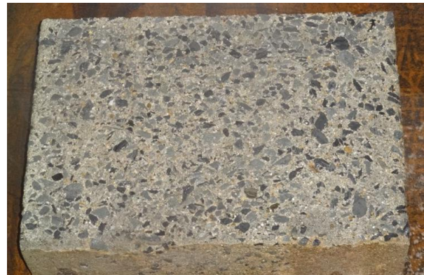
図－6 除染による蓋 4 の表面状態変化 (上：0 秒，中：60 秒，下 240 秒)
