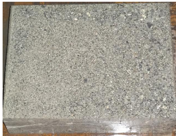
図－7 除染による蓋 5 の表面状態変化 (上：0 秒，中：30 秒，下 330 秒)
