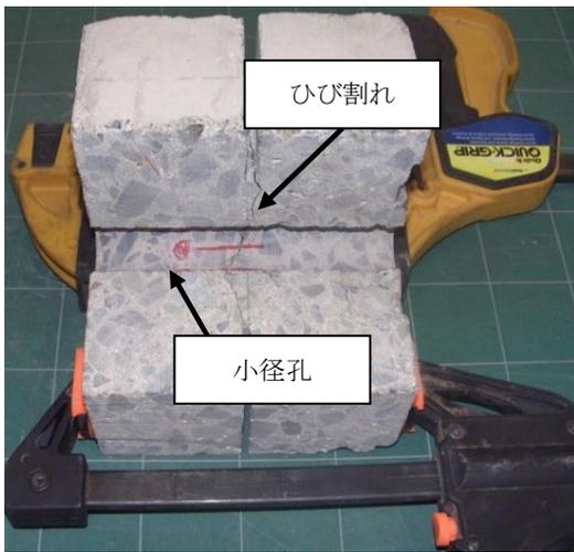
写真-4 横ひび割れ供試体
