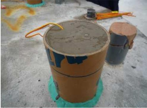
写真 - 11 超速硬無収縮モルタル充填状況 (No.2-3)
