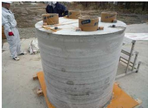
写真 - 5 装薬完了:破砕前 (No.2-1)
