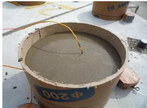
写真 - 4 超速硬モルタル充填 (No.2-1)
