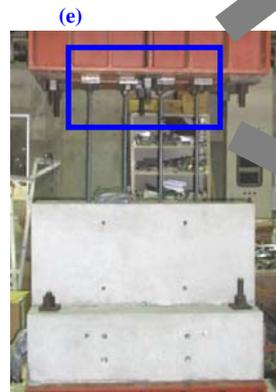
図-8. 試験体加力装置設置状況写真
