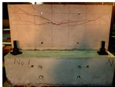
図-11. 最終破壊時(終局時)試験体破壊状況写真(北側)
