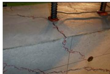
図-13. 最終破壊時(終局時)試験体破壊状況写真(南側上部側面)
