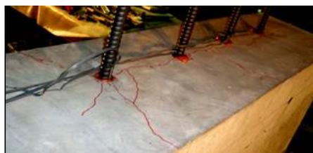
図-12. 最終破壊時(終局時)試験体破壊状況写真(南側上部 4 本)
