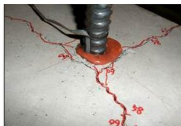
図-14. 最終破壊時(終局時)試験体破壊状況写真(南側上部へりあき部)
