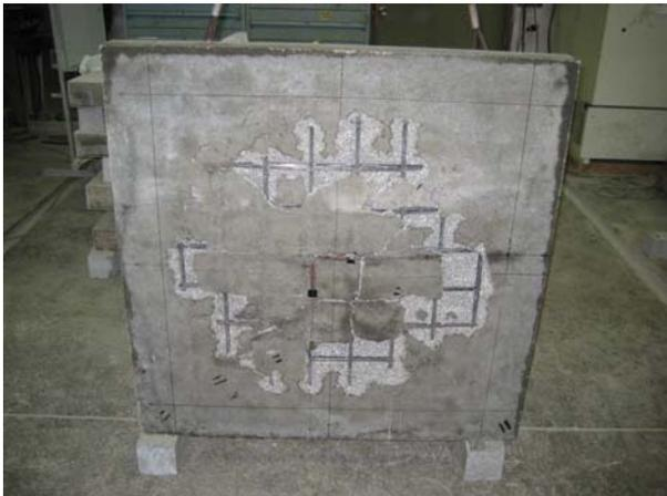
写真-2 破壊後のEPS床版の下面 (No. 6)
