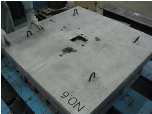
写真-1 破壊後のEPS床版の上面 (No. 6)
