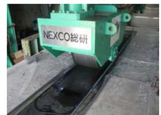
写真-2 移動載荷実験(水張り条件)
