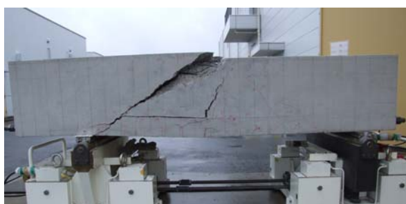
写真-1 B-2 破壊状況（側面）
