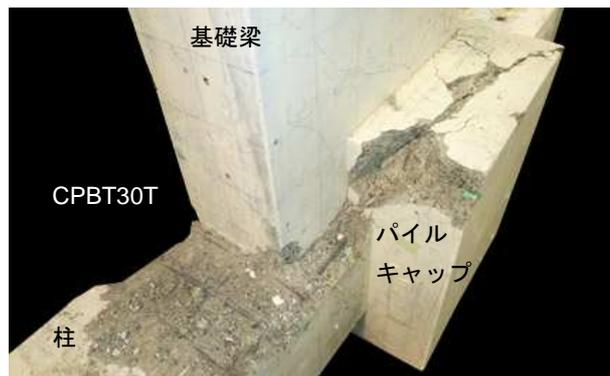
写真-2 最終破壊状況(パイルキャップ)
