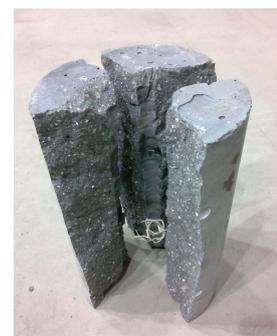
写真-3 割裂破壊状況
