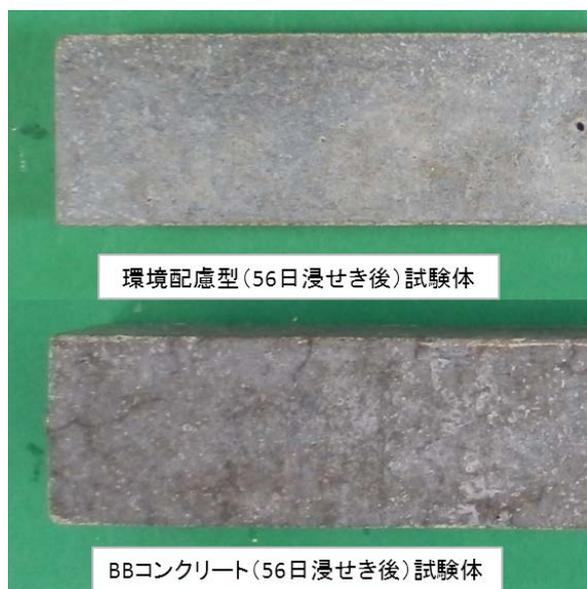
図-13 アルカリシリカ反応促進試験後試験体
