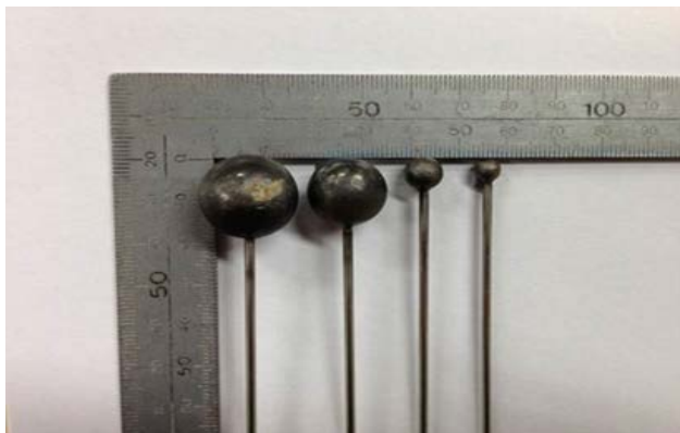
写真-1 鋼球ハンマ（左より直径 18.6, 14.8, 7.0, 5.5mm）
