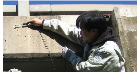
写真-3 縦弾性波速度の測定状況 (A橋)
