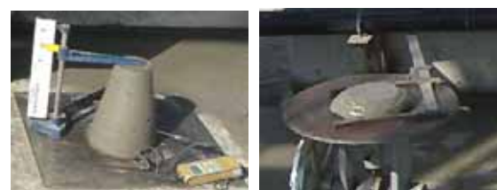
写真-2 スランプ試験、フロー試験状況
