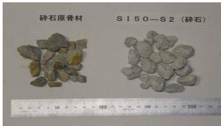
写真-3 骨材粒径比較 (碎石)
