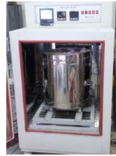
図－2 断熱温度上昇試験装置(50ℓ)
