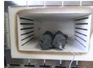
図-3 供試体の加熱試験状況
