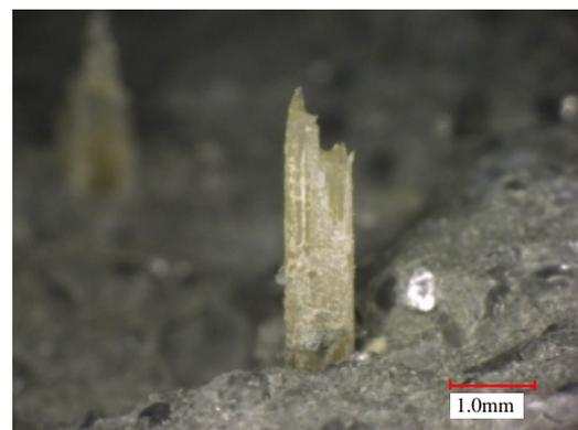
図-11 破断した繊維（光学顕微鏡による観察）
