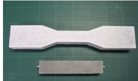
写真-1 ダンベル型供試体と角柱供試体
