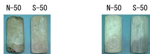
写真-1 各溶液に浸せきしたコンクリートの劣化状況の一例 (材齢 12 ヶ月)
