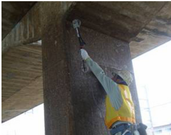
写真-2 自然電位の測定装置
