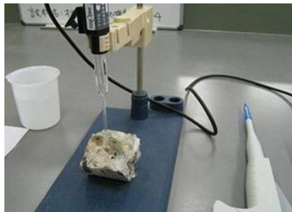
写真-4 pH 計による測定状況 (削孔法)
