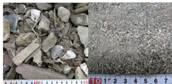
写真-2 溶出試験に用いたがれき （左：粉碎前、右：2mm 未満）
