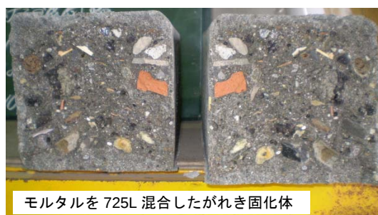
写真-6 曲げ試験後の破壊面の状況
