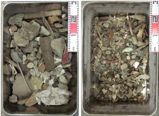
1 次粉碎前のがれき 粒径 25mm 以上 1 次粉碎後のがれき 粒径 40mm 以下
