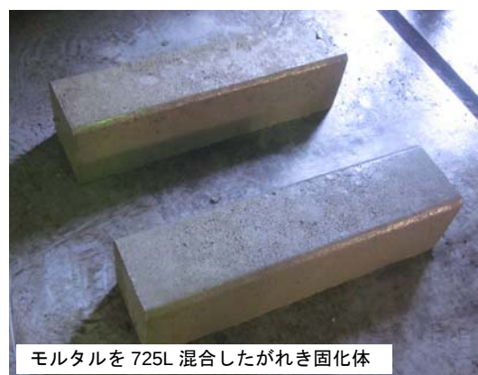
写真-5 即脱後の表面の状況
