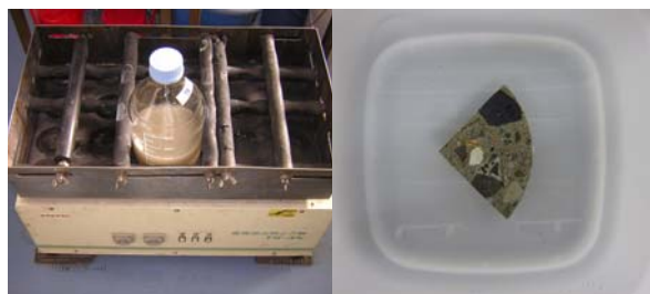
写真-3 溶出試験状況 （左：環告 46 号試験、右：タンクリーチング試験）
