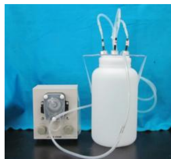
写真-2 通水試験装置
