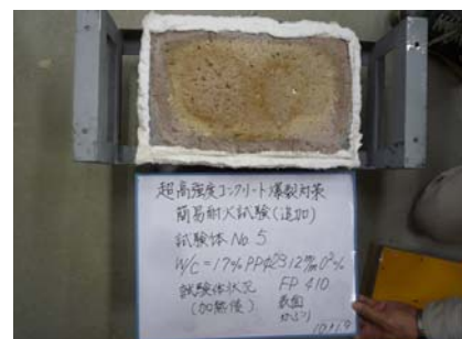
写真－６ 加熱終了後試験体状況(試験体 No.5)
