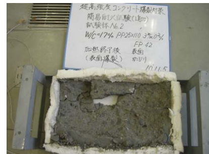
写真－3 加熱終了後状況(試験体 No.2)
