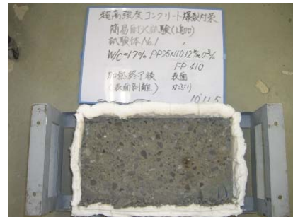
写真－2 加熱終了後状況(試験体 No.1)
