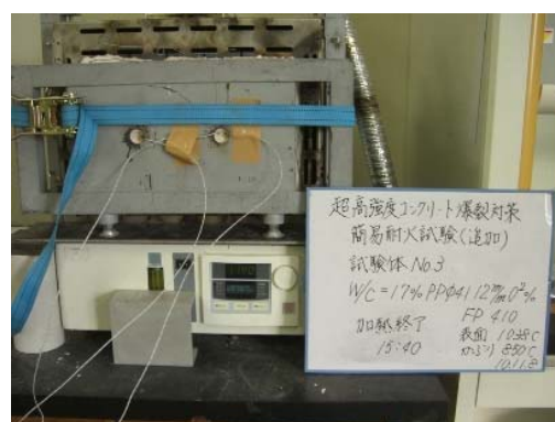
写真－1 電気炉による加熱状況
