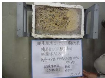
写真－7 加熱終了後状況(試験体 No.6)
