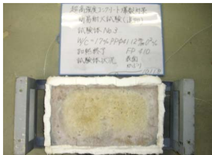
写真－４ 加熱終了後状況(試験体 No.3)
