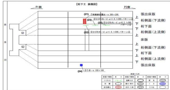
図-11 橋梁点検結果の例(スパン2)
