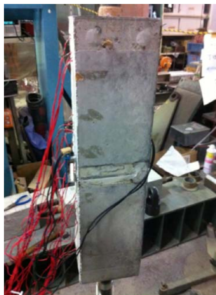
写真一1 一軸引張り試験の様子
