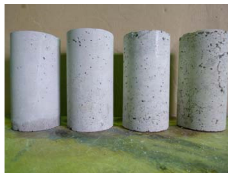
写真-5 圧縮試験用試験体 (左から竹繊維混入量0, 1, 2, 3%)
