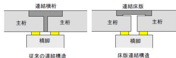
図-2 床版連結構造
