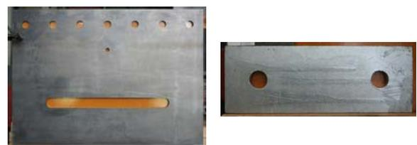
写真-2 ファスナープレートと座金プレートの摩擦面(実験前)
