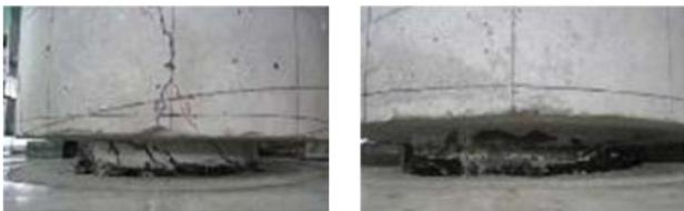
a) No. 3 (挿入部補強なし)      b) No. 4 (鋼管補強)
