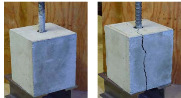
写真-3 最終破壊状況
