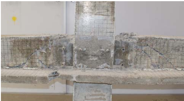
(c)No.3(No.2 の補強からパネル部鋼板一部切除)
