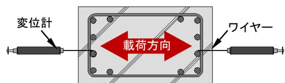
(b)主筋挙動測定部の断面
