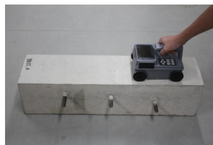
写真-1 電磁波測定の様子
