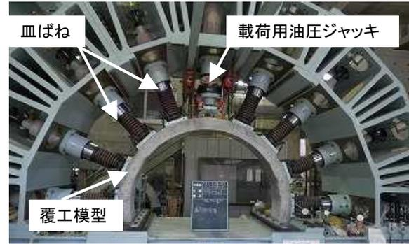
図-2 大型トンネル覆工模型実験装置の状況
