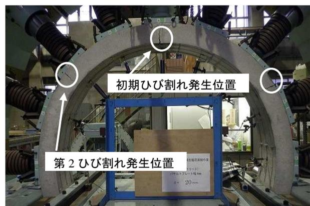
図-10 初期ひび割れと第2 ひび割れ発生位置
