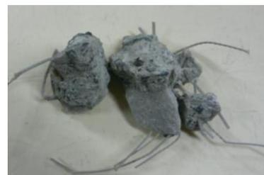
写真-5 繊維が複数のコンクリート塊を架橋している様子
