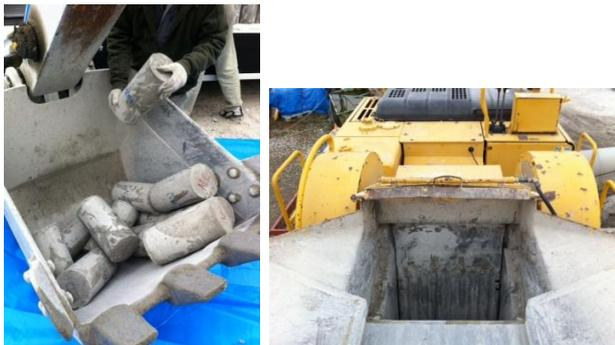
(a) コンクリートの投入状況 (b) クラッシャー投入口
