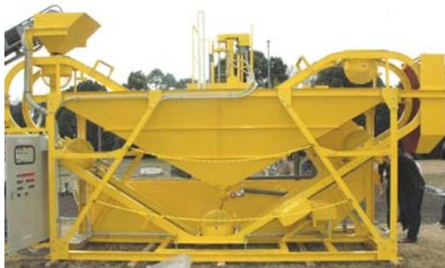
図-2 自動パルス再生骨材製造プラント
