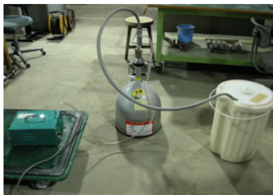
写真-2 簡易急速凍結融解試験装置
