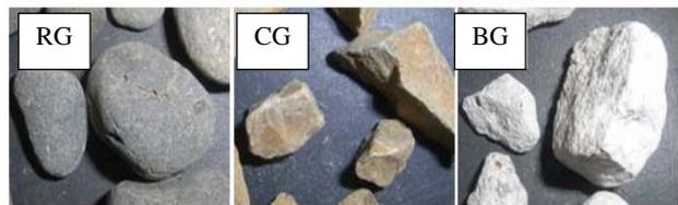
写真-3 粗骨材の外観
