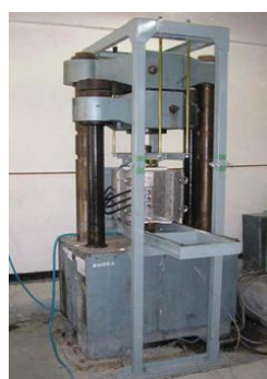
図-2 加熱試験装置全景及び加熱炉詳細図
