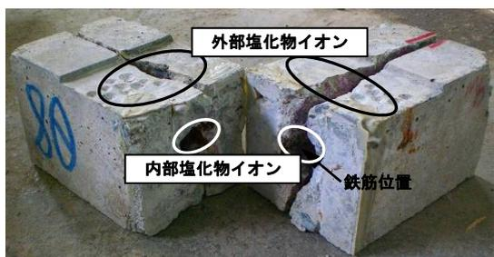
写真-2 コンクリート粉末採取箇所
