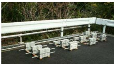
写真-4 暴露試験 試験体設置状況
