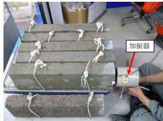
写真－1 振動試験の状況
