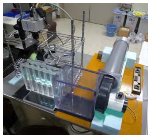
図-5 空気を用いた微速透過試験装置の概要 (上図:概要, 下図:実物の写真)
