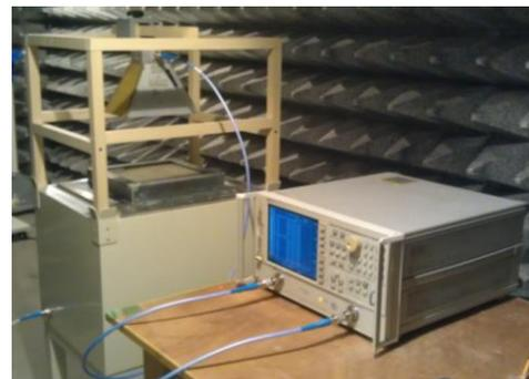
写真-2 電波暗室内の測定装置
