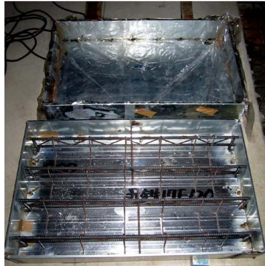
写真-1 ダミー試験体用型枠(無筋・有筋)
