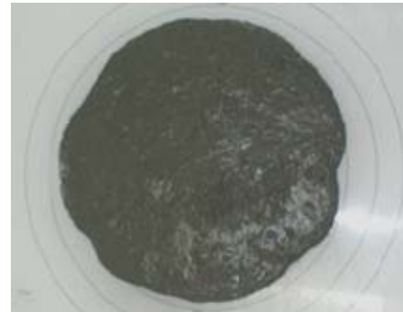
写真－８ 圧送後のフロー試験状況
