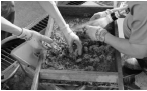
写真-6 鋼繊維の洗い試験状況
