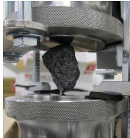
図-2 骨材の設置
